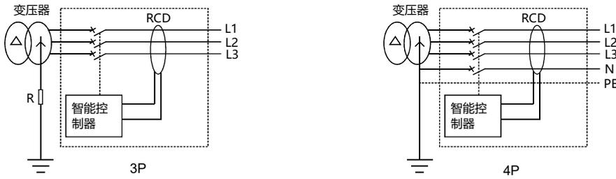
RCD:零序电流互感器
