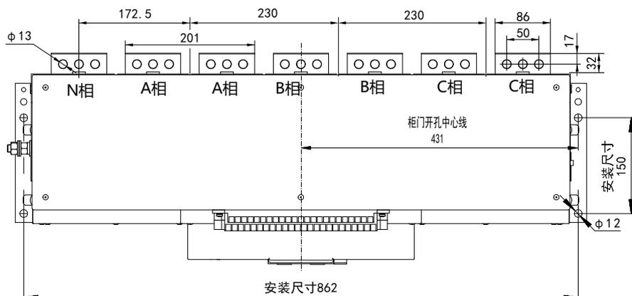
N型 4极安装尺寸及水平接线尺寸
