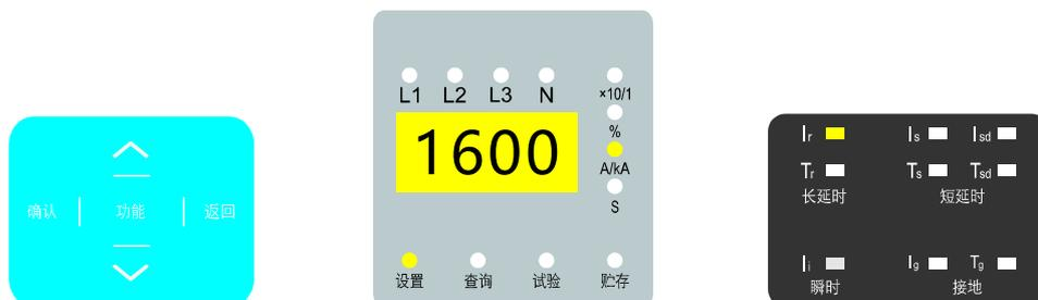
按“功能”键, “设置”指示灯闪烁, 再按“确认”键, 设置指示灯恒亮, 同时“Ir”灯亮, 显示屏显示“1600”及“A/kA”指示灯亮; 再按“确认”键, 然后按“^”、“v”键修改数值至“800”, 再按“确认”键保存, 此时“贮存”指示灯闪烁; 保存完毕后按“返回”键返回至设置主菜单; 然后可继续按“^”、“v”键选择其它参数设置, 或继续按“返回”键退出设置主菜单。
