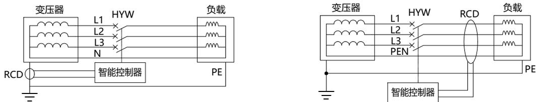
TN-S系统RCD互感器安装位置示意图
