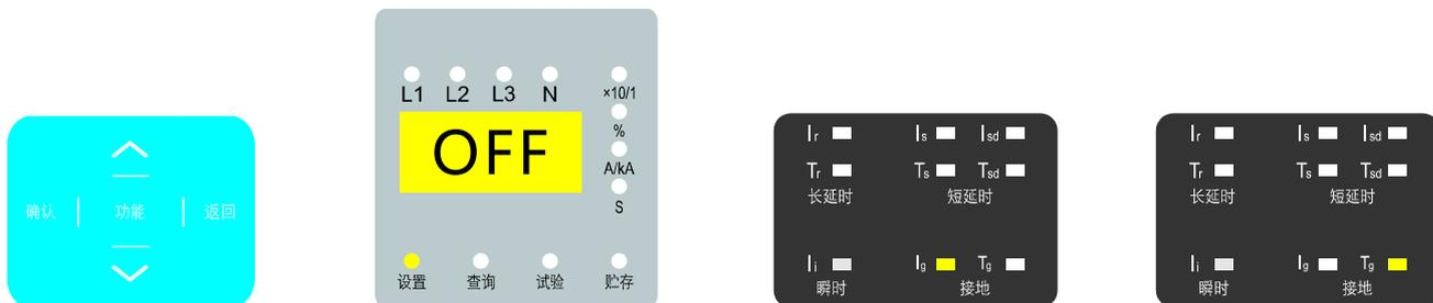
按“功能”键，“设置”指示灯闪烁，再按“确认”键，设置指示灯恒亮，同时“lr”灯亮；按“^”、“v”键切换设置参数选项直至“lg”灯亮，此时显示屏显示“OFF”，然后按“确认”键，再按“^”、“v”键修改数值至500，再按“确认”键保存，此时“贮存”指示灯闪烁；保存完毕后按“返回”键返回至设置主菜单；然后再按“^”、“v”键至“Tg”指示灯亮，此时显示屏显示“OFF”，按“确认”键，再按“^”、“v”键修改数值至0.4，再按“确认”键保存，然后按“返回”键退出。
