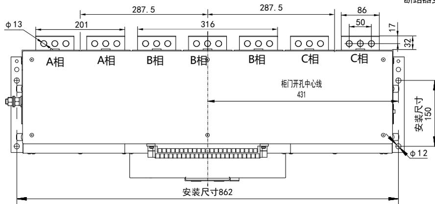
N型 3极安装尺寸及水平接线尺寸
