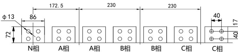
H型 4极水平接线尺寸
