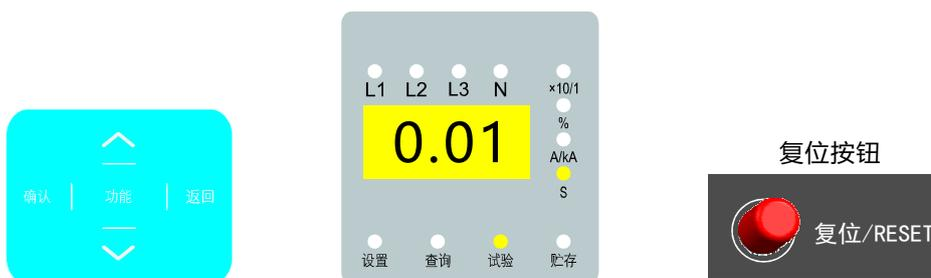
按“功能”键，“设置”指示灯闪烁，再按“功能”键直至“试验”指示灯闪烁，按“确认”键，“试验”指示灯恒亮；再次按“确认”键，开关脱扣，显示屏显示脱扣时间0.01s。试验完后需将断路器复位按钮复位，并按“复位”键恢复初始界面。
