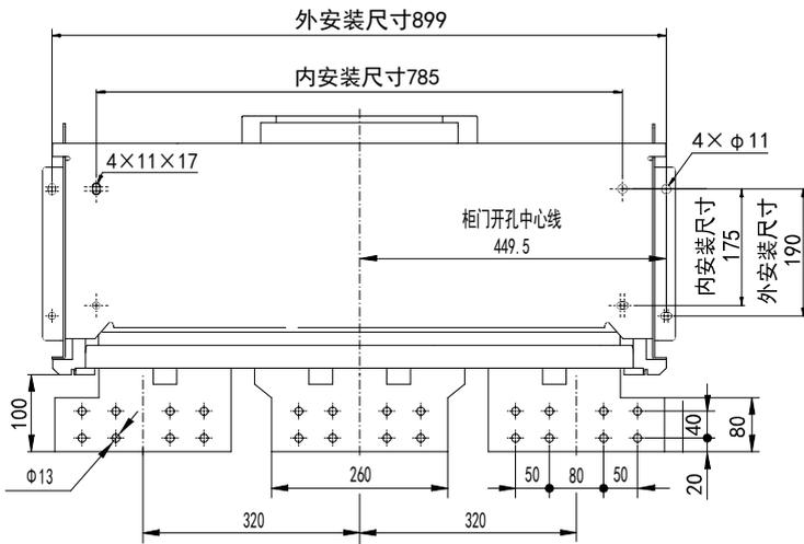
3极水平接线及安装尺寸
