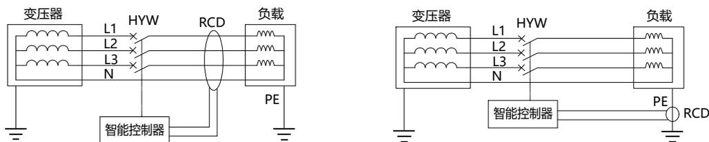
TT系统RCD互感器安装位置示意图
