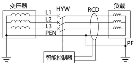
TN-C-S系统RCD互感器安装位置示意图
